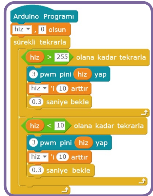
Şekil 148: Motor hız kontrol devresi kodları
